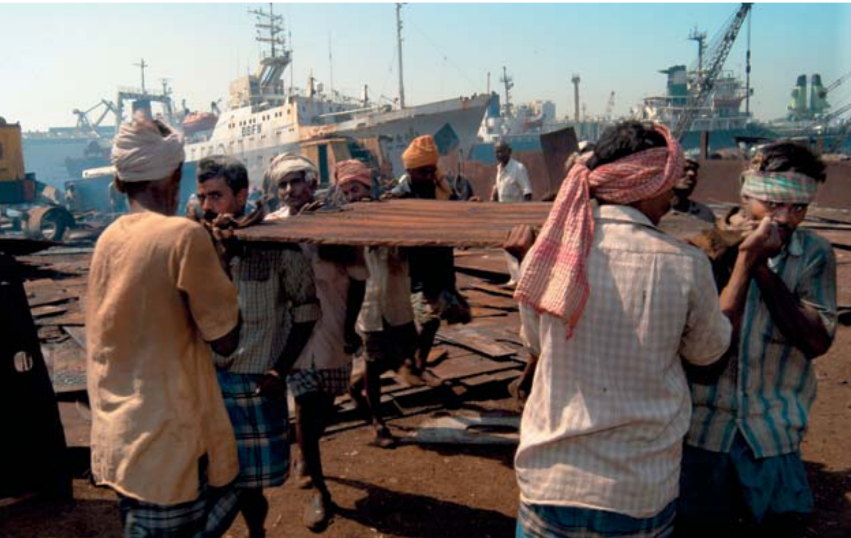
Para levantar una plancha de acero desde la playa contaminada con aceite y llevarla hacia un lugar de carga, se requiere de ocho a 10 hombres.
